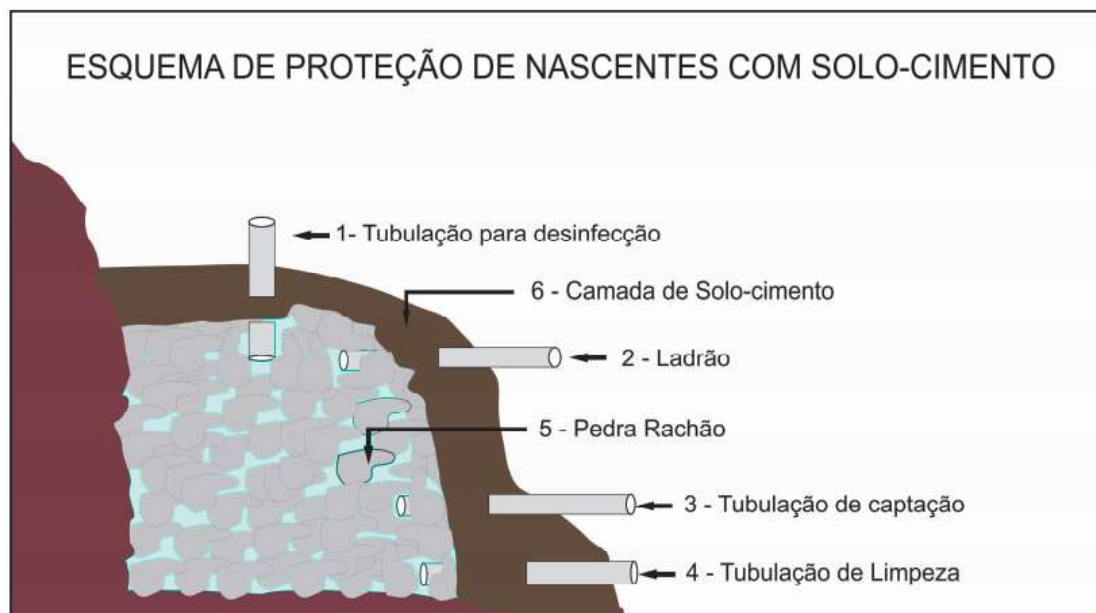
Figura 1. Esquema de proteção de nascentes com solo-cimento (Fonte: CRISPIM et al., 2012).
