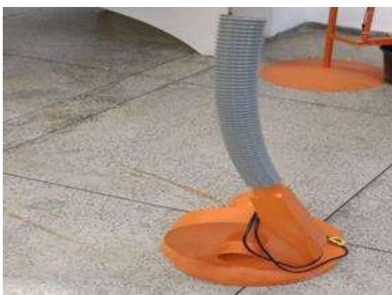
Figura 3: Jato de ar, utilizado na explicação do princípio de Bernoulli
