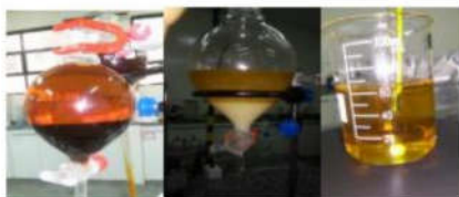
Figura 1: Processo de transesterificação metílica utilizando as amostras coletadas nos locais Y e Z, gerando biodiesel como produto final.
