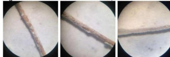
Observa-se que a quantidade de caulim é alta, pois deixa uma camada excessiva que pode ser retirada no momento da aderência com a resina, não exercendo o seu papel de aumentar a ancoragem fibra-matriz.
