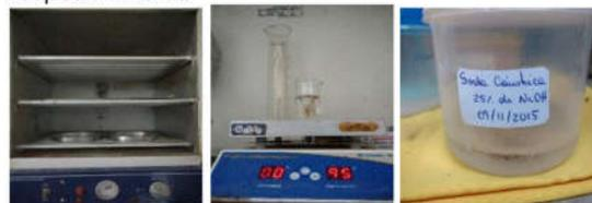
O tratamento com soda cáustica (solução com 25% de NaOH), foi feito durante tempos diferentes (20min, 15min, 10min e 5min) para alcançar aquele que teria maior eficiência. E o tratamento de amido/caulim foi feito em proporções diferentes de amido (10%,
