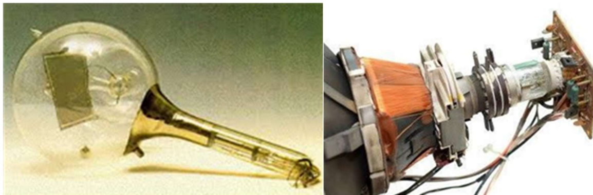
FIGURA 01. a) Ionoscópio patenteado por Wladimir Zworykin. b) Tubo de vácuo que contém um cátodo aquecido e dois ou mais ânodos em forma de anel, através dos quais os raios catódicos podem passar de modo a chocarem na extremidade mais longa do tubo.
