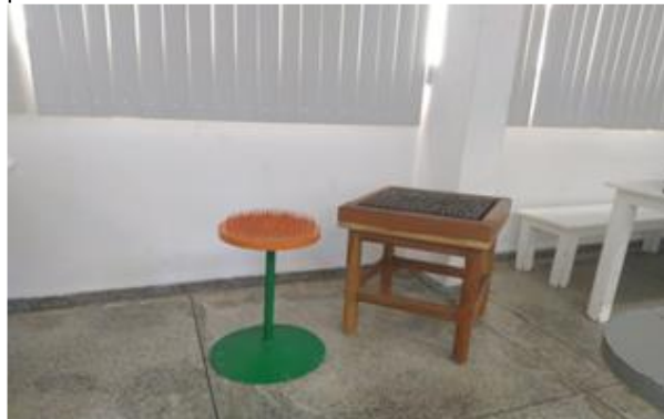
Figura 4: Banco giratório, utilizado na explicação de conservação do momento angular
