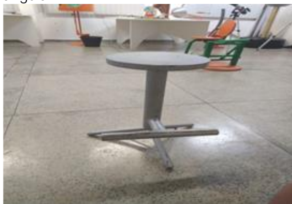
Figura 4: Banco giratório, utilizado na explicação de conservação do momento angular
