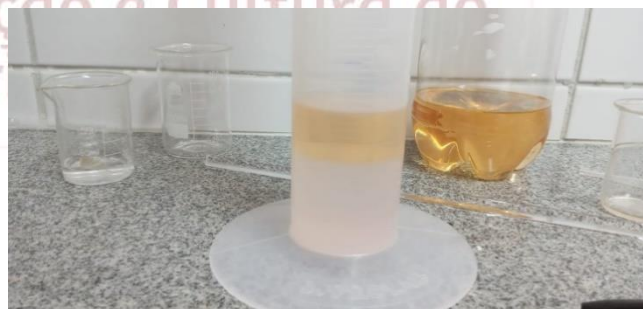
Figura 4. Sistema gasolina/água após mistura e descanso. Nota-se claramente que o volume da fase aquosa (inferior) fica maior que o volume da fase orgânica (superior) pois o etanol foi transferido de uma fase para a outra. O volume das fases iniciais são os mesmos. Serrinha/BA, 2022.
