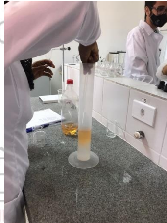
Figura 2. Estudante realizando mistura da amostra de gasolina com água. Serrinha/BA, 2022.
