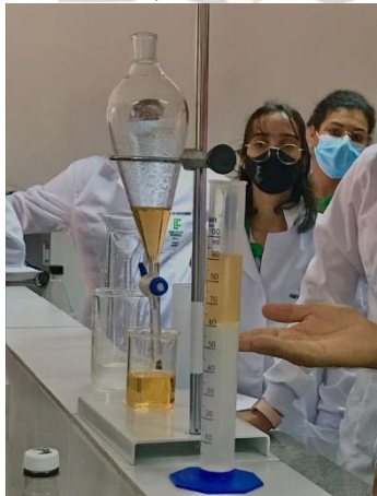
Figura 1. Proveta contendo mistura de gasolina (fase superior, amarela) e água (fase inferior, incolor). Serrinha/BA, 2022.
